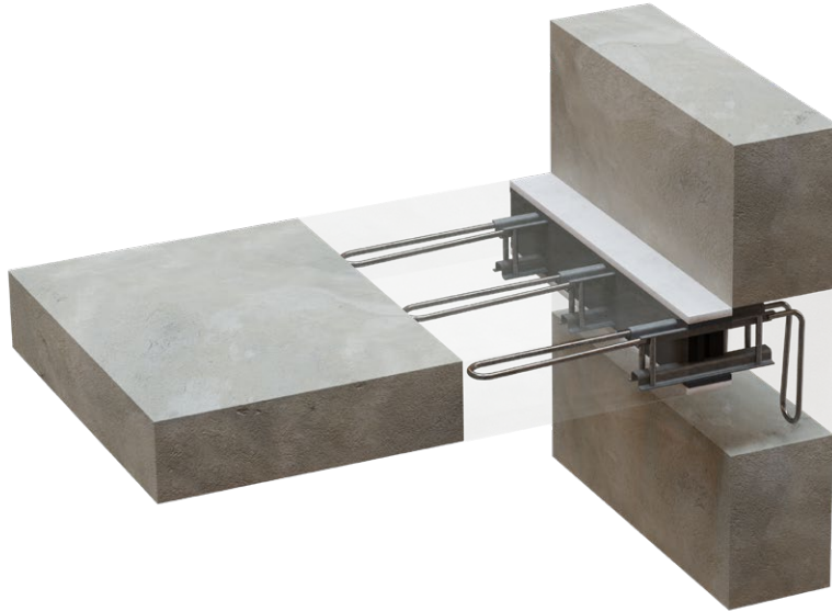
Abb. 7. Bewehrungsanschluss TIPOMEGA®, zu verankern in der Wand unter Einsatz der Stäbe mit der Form UD3, die am oberen Profil angeschweißt sind und nach unten gebogen sind
